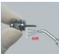
4. **Soufflez l'air du côté de la fraise** à l'aide d'une seringue.
