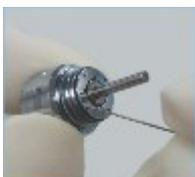
5. Insérez l'aiguille pour le nettoyage de l'embout dans l'orifice du spray depuis le côté de la tête. **Éliminez l'adhésion de saletés** à l'intérieur.
